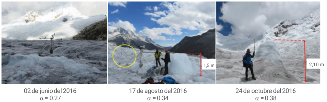
Figura 12. Mediciones de la altura conservada con balizas de control en el área experimental. Las fotografías muestran el valor del albedo del área circundante al área experimental, así como la altura de masa preservada en ésta última según cada fecha de medición (UGRH-ANA, 2016).
